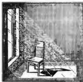
Илл. 5. Световое пятно на полу от окна и тень от стула при солнечном освещении являются параллельной проекцией предмета
