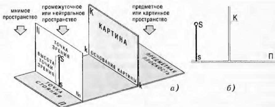
Илл. 9. Элементы проецирующего аппарата центрального проецирования (а) и его профильное изображение (б)
