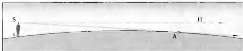
Илл. 24. Схема определения теоретического и действительного горизонта
